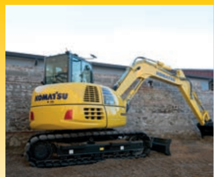
Kinderleichtes Grabenziehen dank reduziertem Frontschwenkradius und Auslegerschwenkfunktion
