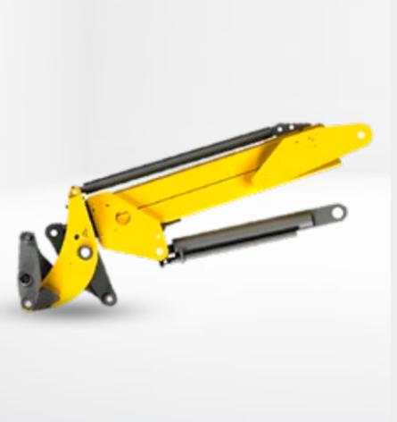
Die kompakte Kastenbauweise der Teleskopladeanlage macht die Sicht auf das Anbaugerät einzigartig. Die Vorteile der Z-Kinematik: Beim Einkippen der Schaufel wird bei gleicher Zylindergröße eine höhere Reißkraft erzeugt, da die Kolbenseite des Hydraulikzylinders beim Einkippen beaufschlagt wird.
