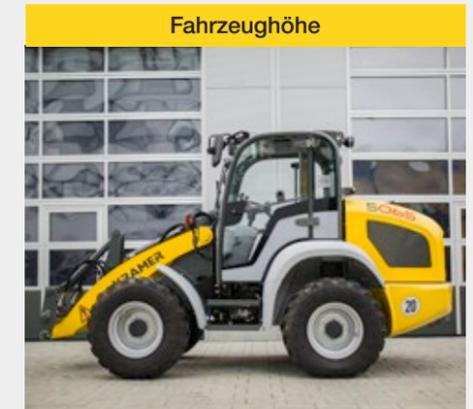
Die Maschinen bieten die besten Voraussetzungen für niedrige Einfahrtshöhen. Durch die kompakte und niedrige Bauweise der Rad- und Teleskopradlader von unter 2,5 m, sind die Maschinen auch innerhalb von Gebäuden, wie z.B. in Tiefgaragen ideal einsetzbar.
