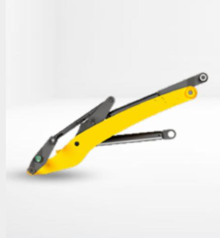
Die parallel geführte Ladeanlage gewährleistet konstante Hubkraft und eine sichere Bedienung im Materialumschlag. Durch einen Rückkippwinkel von 50° und einen Auskippwinkel von 45° verliert der Radlader im Schaufeleinsatz auch bei hohem Füllgrad kein Material und ermöglicht ein vollständiges Entleeren der Schaufel.
