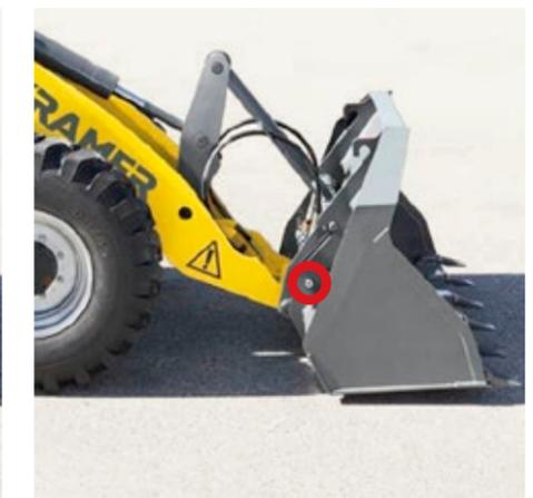
**Hydraulischer Gerätewechsel - Das Kramer Schnellwechselsystem:** An das Anbaugerät heranfahren, das Anbaugerät vom Fahrersitz aus aufnehmen und per Tastschieber am Joystick hydraulisch verriegeln. Der Verriegelungszyylinder liegt außerhalb vom Drehpunkt der Schnellwechsellplatte und ist somit nicht im Schmutzbereich.
