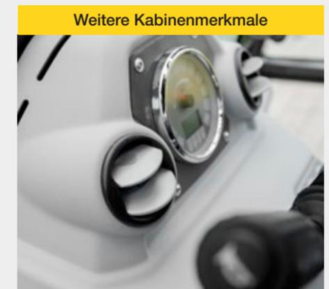
Das kombinierte Brems-Inch Pedal ermöglicht ein feinfühliges Rangieren auch bei hoher Motordrehzahl. Die leistungsstarke Heizung mit Scheibenbelüftung und Heizdüsen im Fußraum sorgen für angenehmes Arbeiten auch an kalten Tagen. Optional ist eine vollintegrierte Klimaanlage erhältlich.\*
