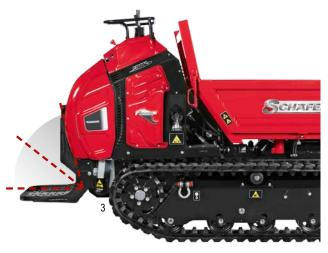
Die Mitfahrplattform kann für den Transport oder auf engen Baustellen einfach nach oben geklappt werden.
