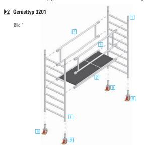
Die Lenkrollen 9 in die Standleitern 1 einstecken und durch Schrauben M 12x60 mit selbstsichernden Muttern befestigen. Die beiden Standleitern 11 durch 2 Doppelrückenlehnen 5 verbinden und damit aussteifen. Die Durchstiegbrücke 2 ist in die von unten 4. Sprosse einzuhängen. Die Einrastklauen aller Teile sind dabei von oben her in die Standleitersprossen 1 einzurasten.
